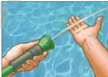
Рис. 72. При ламинарном течении площадь сечения трубки тока сохраняется
