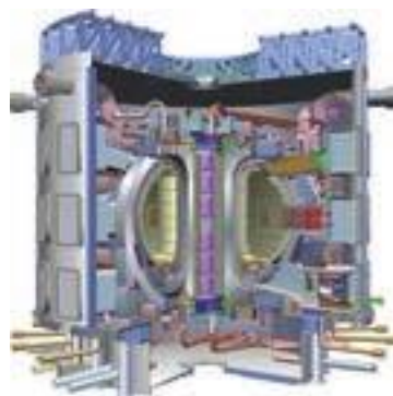
Рис. 295. Камерой токамак является вторичная обмотка трансформатора
