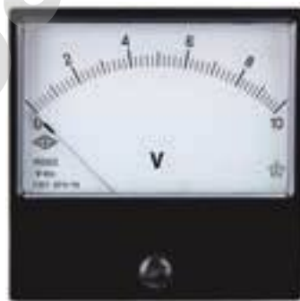
Рис. 4. Шкала вольтметра с классом точности 2
