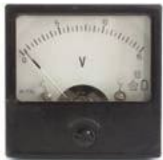
Рис. 6. Лабораторный вольтметр класса точности 2,5
