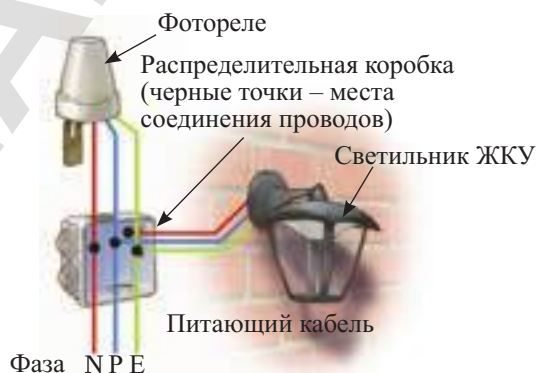
Рис. 230. Схема подключения фоторезистора в цепь уличного освещения
