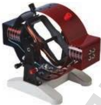
Рис. 336. Модель электродвигателя для школьной лаборатории
